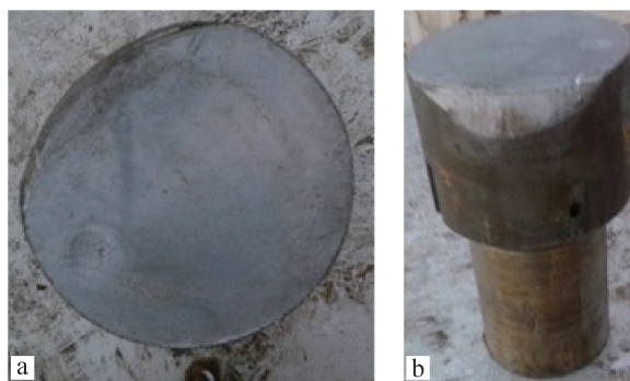
图3 四川盆地某套变井铅模打印结果
